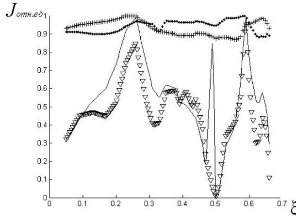
Рис. 3. Информационные меры в случае изменения положения крайнего импульса в эшелоне объектного импульса.  $\xi = \tau_1 / (\tau_1 + \tau_2)$ ;  $\theta = \pi/2$  — площадь объектного импульса;  $n = \sigma \cdot \delta t > 4$ , где  $\sigma$  — ширина неоднородно уширенной линии,  $\delta t$  — длительность всего эшелона импульсов.
